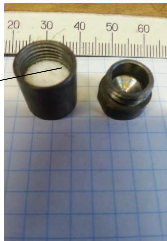
Капсула с мишенным веществом до нагрева
