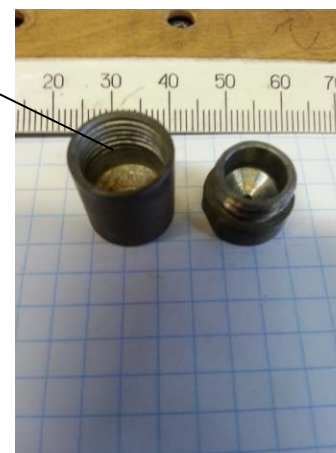
Капсула с мишенным веществом после нагрева
